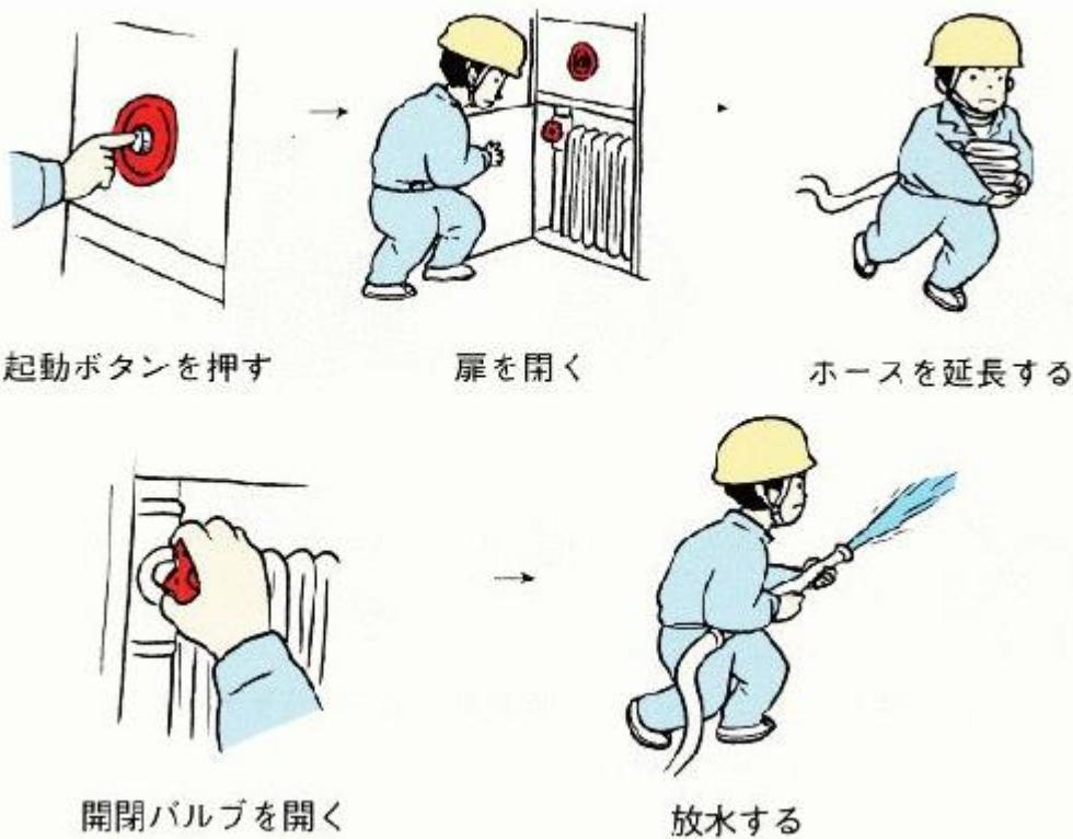
② 消火器以外の防火機器は、室内が一定の状況になると自動で作動する。しかし、手動でも作動が可能
