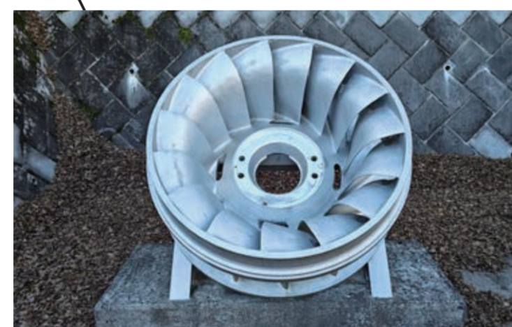
多摩川第一発電所で かつて使われていた水車 （東京都青梅市）
