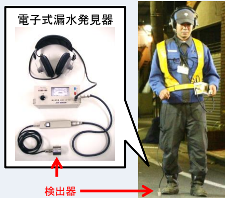
電子式漏水発見器 騒音の少ない夜間、検出器を地表面に置き、漏水音をヘッドホンで聞き取ります。
