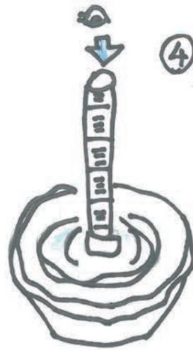
④ 洗面器の中に透視度計を立てて水をゆるめ少しずつ水が流れ出るようにする。十字が見えたら水を止めて水をためる。管に残っている水の目盛りを読む。
